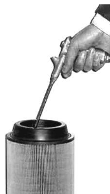
Рис. 6.3 Очистка фильтрующего элемента воздушного фильтра
